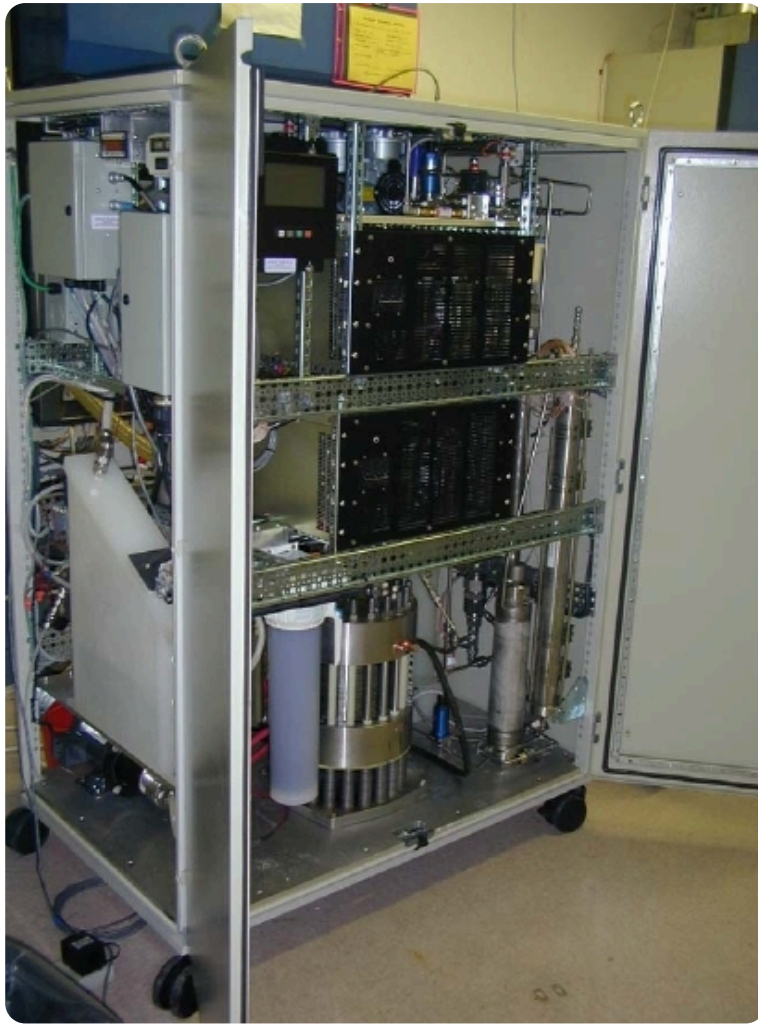
Hochdruck-PEM-Elektrolyseur (Foto: U.S. Department of Energy, Public domain, via Wikimedia Commons) — industrielle Technik, zeigt den Aufbau
